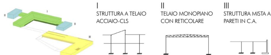
Per gli edifici monopiano con altezza interna elevata, palestra e auditorium, è stato utilizzato uno schema strutturale semplice a telaio con trave reticolare e diagonali compresse a doppia pendenza in copertura, capaci di coniugare leggerezza, resistenza e semplicità di esecuzione.
